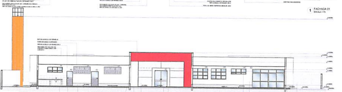
2 FACHADA 01-REM FECHAMENTO EM CHAPA METÁLICA ESCALA 1:75
